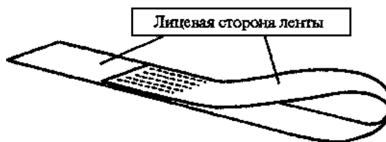
Рис. 6. Скрученная петля стропа
